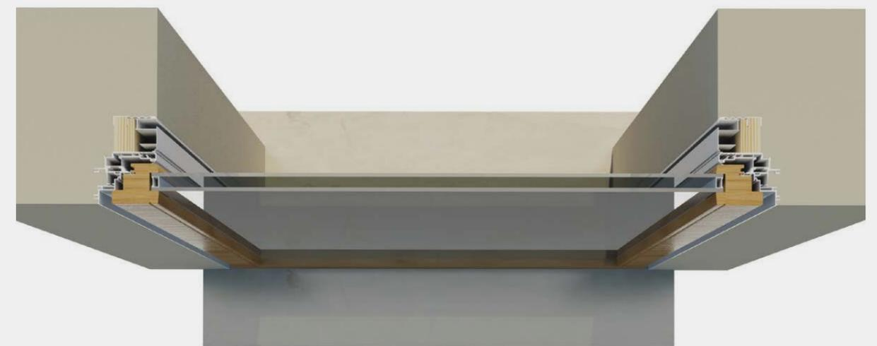
Sezione orizzontale | Horizontal section | Section horizontale | waagrechte Schnittansicht
